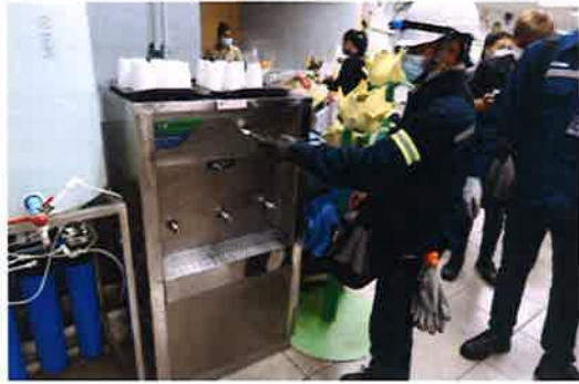
ตรวจสอบกระแสไฟรั่วของตู้กดน้ำดื่ม
