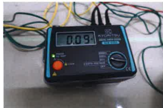
ค่าความต้านทานดินของหม้อแปลง 0.09 โอห์ม
